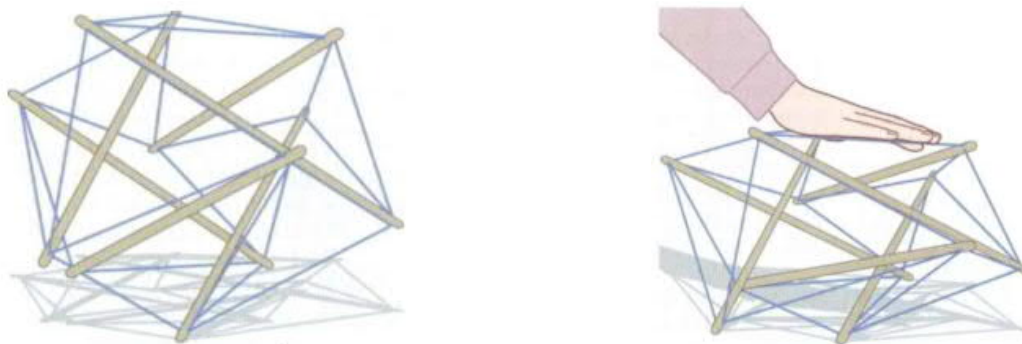
Obrázek 5. Vlastnosti tensegritické struktury (Myers, 2009)
